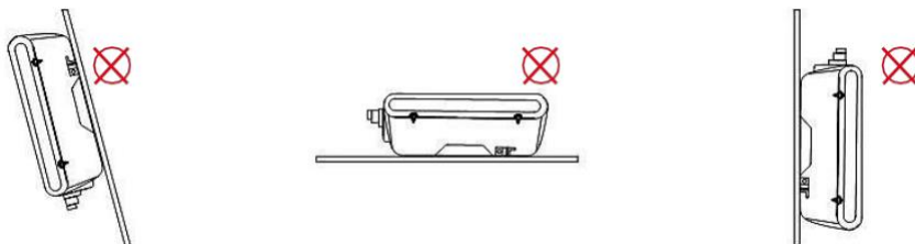
Rysunek 4.9 Niewłaściwe tryby instalacji
