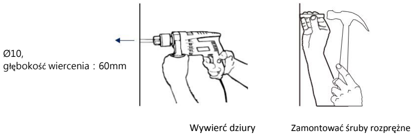
Rysunek 4.12 Otwory i instalacja (jednostka: mm)
